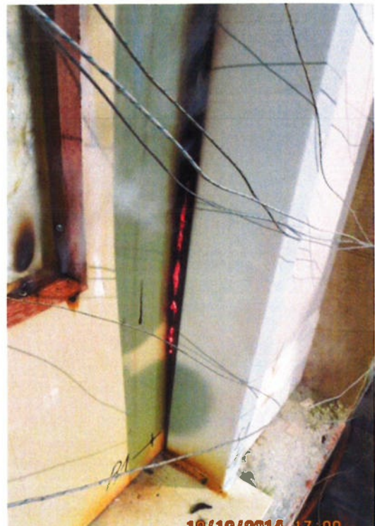
Probekörper in der 59. Prüfminute (Band- und Schlossseite)
