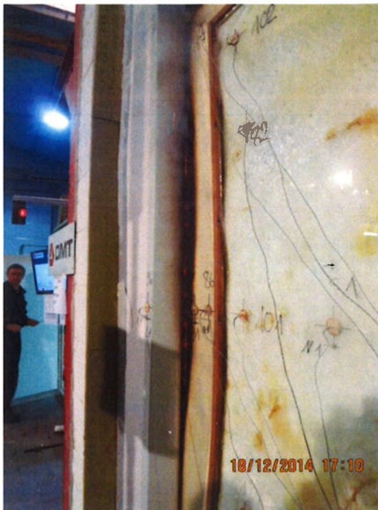
Probekörper in der 59. Prüfminute (Band- und Schlossseite)
